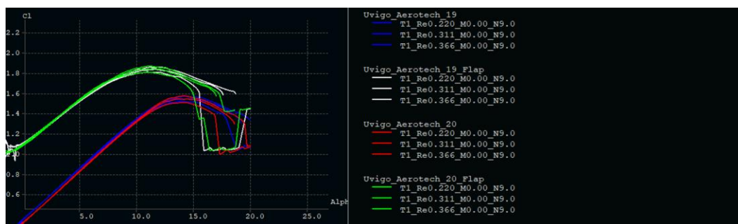
Ilustración 6. Curvas de C_L obtenidas en XFLR5 para los perfiles dados
