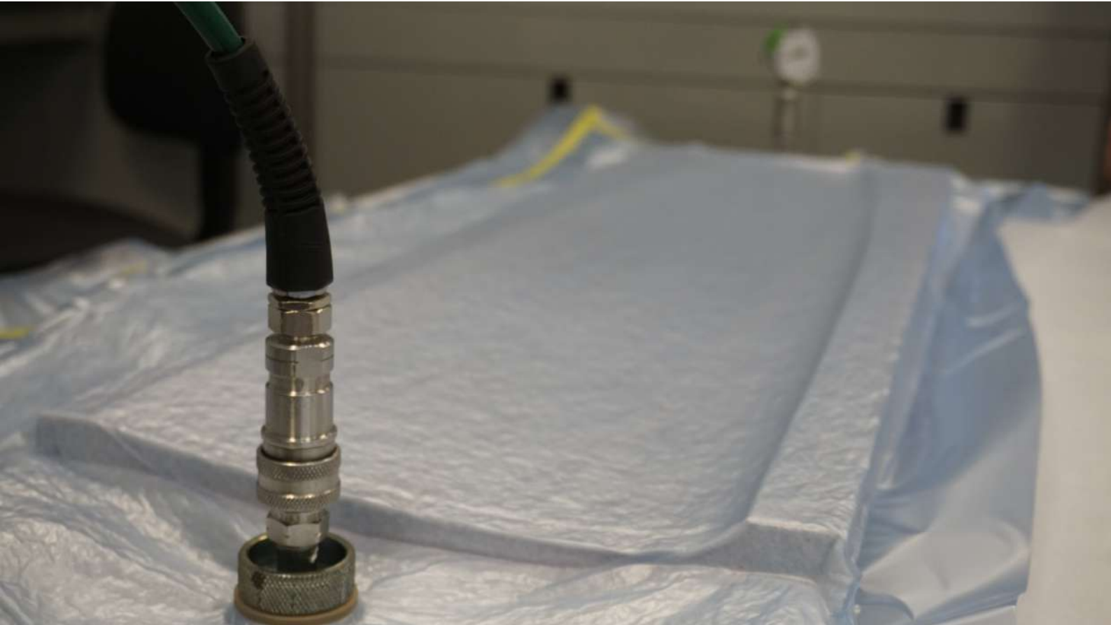
Utilizamos una bomba de vacío para despresurizar las bolsas antes de ser sometidas a ciclo.
